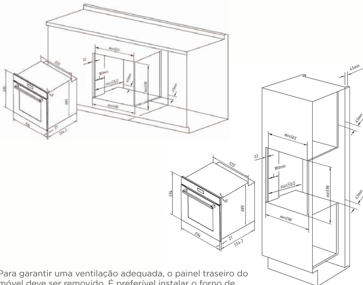
Para garantir uma ventilação adequada, o painel traseiro do móvel deve ser removido. É preferível instalar o forno de forma que ele assente sobre duas tiras de madeira. Se o forno repousar sobre uma superfície plana e contínua, deve haver uma abertura de pelo menos 45x560mm
